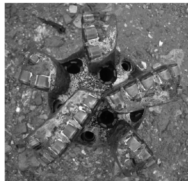
图 3 旋流喷嘴钻头试验后照片
