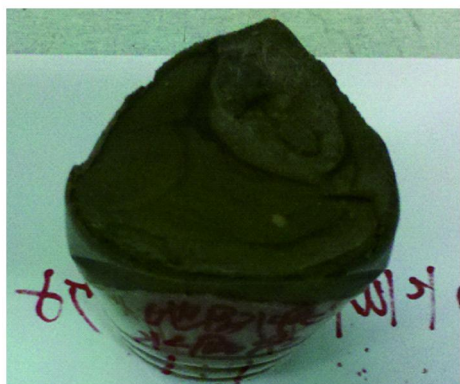
图 8 地层浆体及固体物与水泥的胶结物
