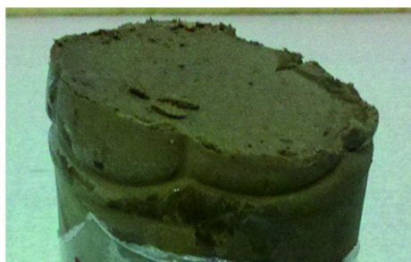
图 7 1:1 地层中的浆体与水泥浆胶结物
