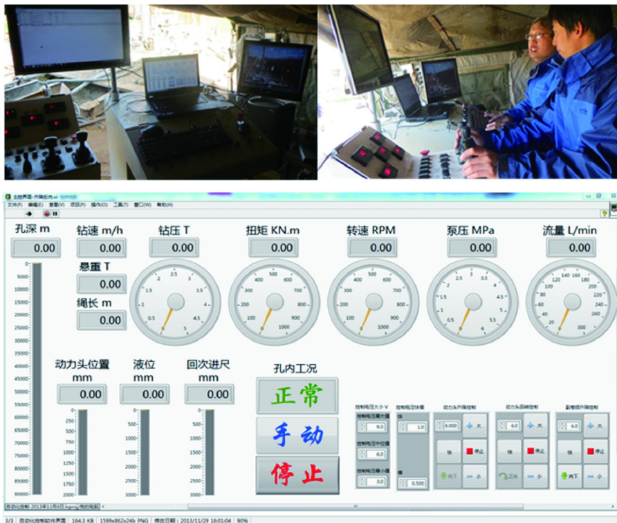
图 2 孔内典型异常工况识别及钻机自动化控制系统
