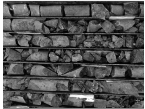
图 1 烧钻事故段的岩心
