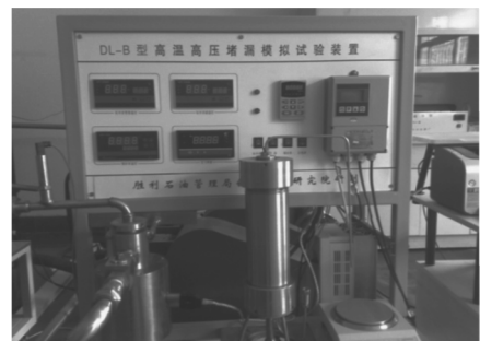
图 6 DL-B 高温高压堵漏模拟试验装置
