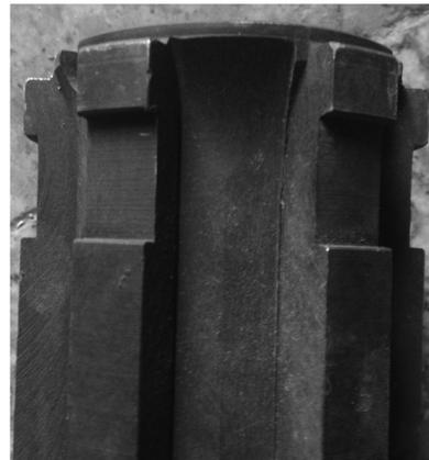
图 4 带倒角反循环钻头尾部实物
