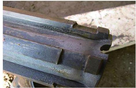
图 11 钻进 60 m 后的改进钻头尾部
