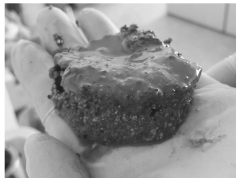
图2 高渗透性漏失封堵效果图
