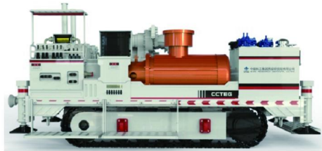
图1 ZDY12000LD 型大功率定向钻机
