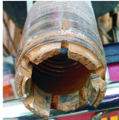
图4 试探斜面造成钻头损坏情况
