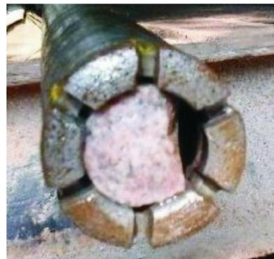
图5 造斜钻头正常磨损情况
