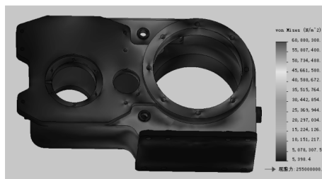
图 2 箱体应力变形图
