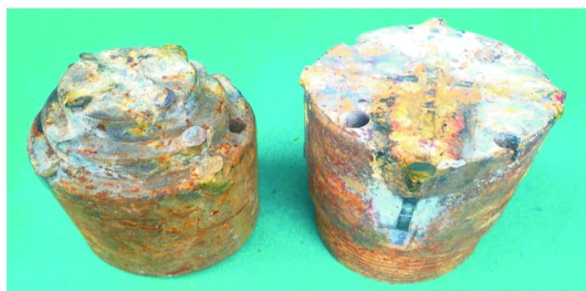
图 4 \varnothing 95 mm 硬质合金镶焊的实心钻头
