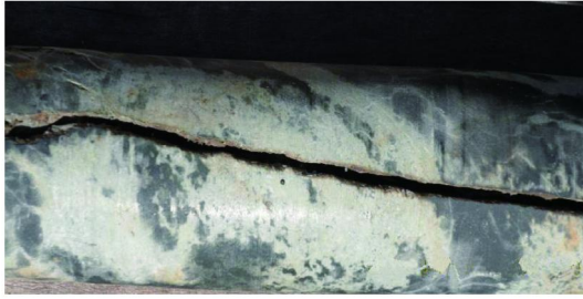
图1 保山金厂河矿区裂隙贯通实物岩心
