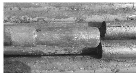
图8 完成作业的“炮弹”式打捞器
