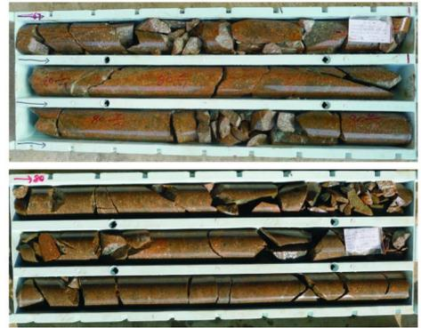
图 5 使用液动冲击器在构造破碎带采取的岩心照片
