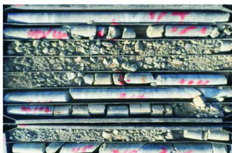
图1 蚀变破碎带与软硬互层地层岩心
