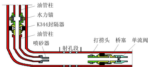
图2 可钻桥塞分段压裂示意图
