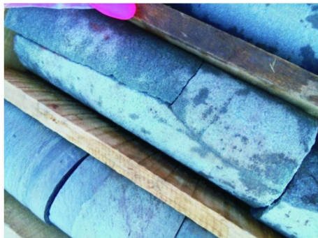
图 2 刘家沟组存在纵向裂缝
