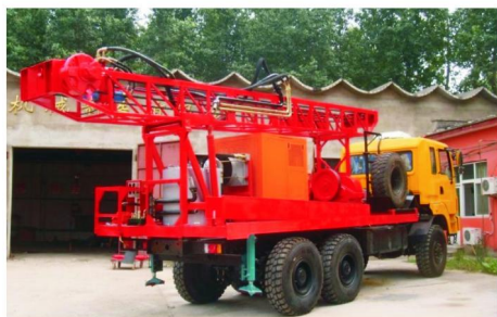
图5 TGQ-100C 车装取样钻机
