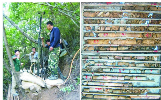
图12 野外施工情形及浅钻获取的岩心样品
