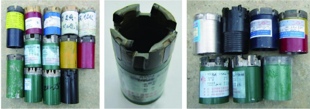
图5 浅钻配套使用的各类钻头
