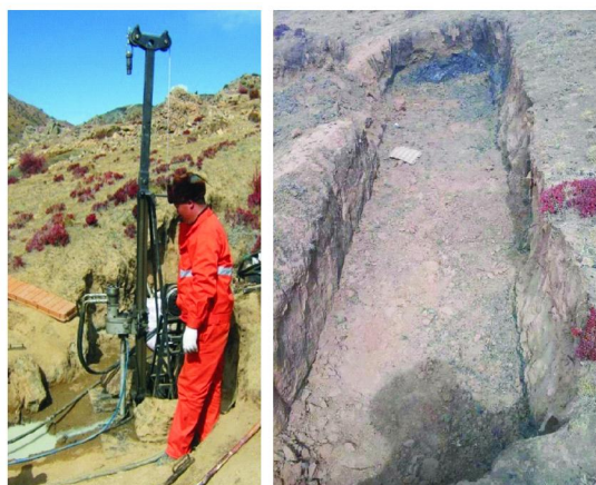
图10 浅钻与槽探相比具有深度的优势
