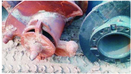
图2 钻进用长螺旋钻头和厚壁钻杆
