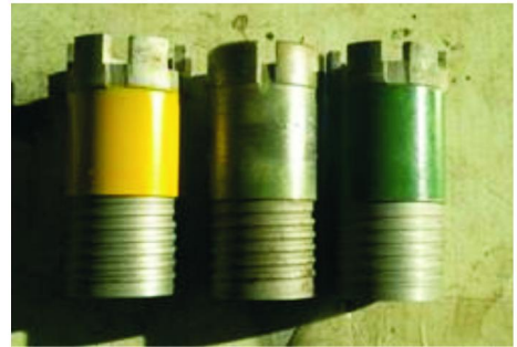
图 6 不同配方的金刚石钻头
