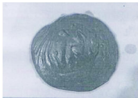
图 3 25% 水泥 + 75% 钻井液养护 20 min 后图样
