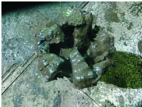
图5 泥包钻头照片
