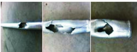
图8 7075 铝合金钻杆静水外压断裂情况
