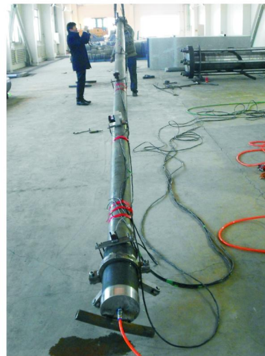
图2 静水内压试验装置
