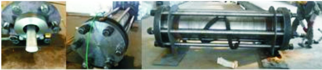
(a) 静水外压试验装置
