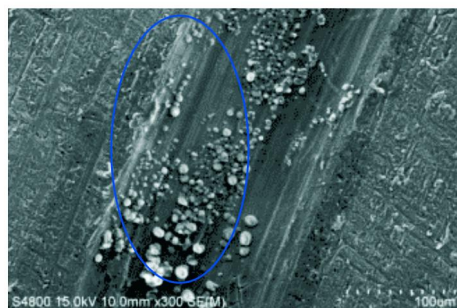
图10 磨损轨迹内团聚的纳米SiO 2 颗粒
