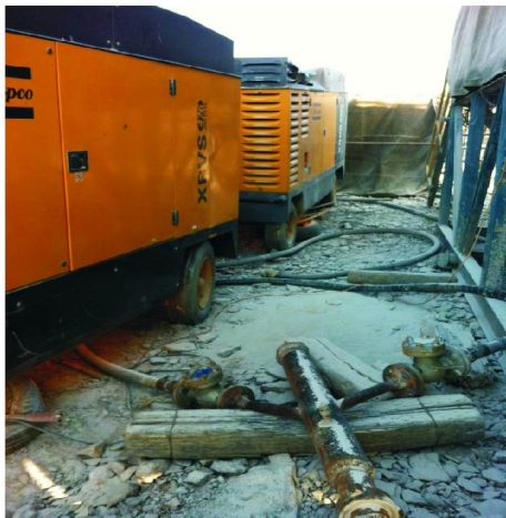
图6 2台空压机并联使用
