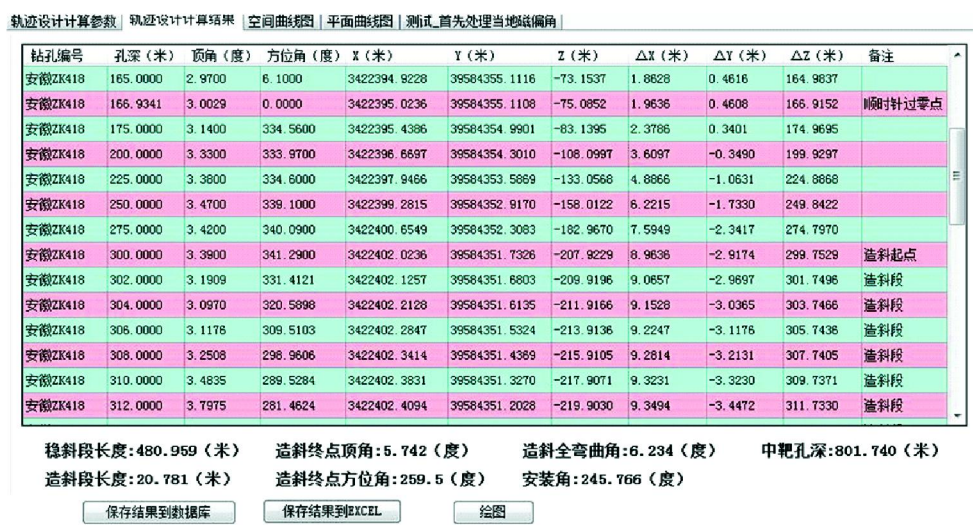
图 8 受控定向孔轨迹设计计算结果
