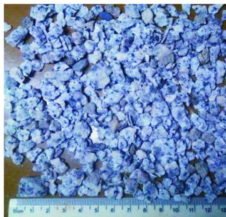
图 5 钻进上返的大粒径岩屑照片
