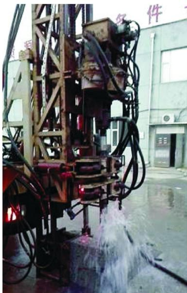
图 4 SC-86H 型高能射流式液动锤地面钻进试验现场
