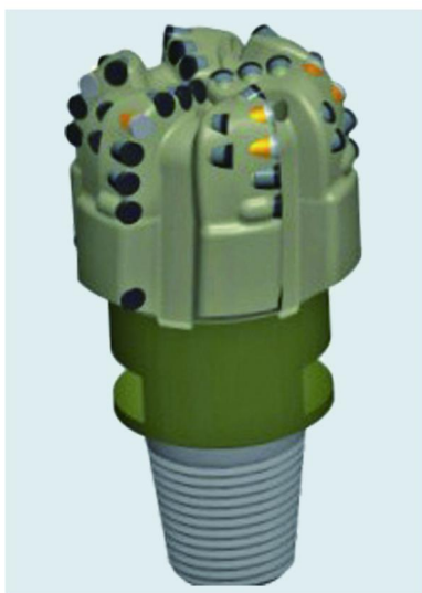
图 7 配置 7 个 ONYX 360°滚动 PDC 齿的 MSiR613 钻头
