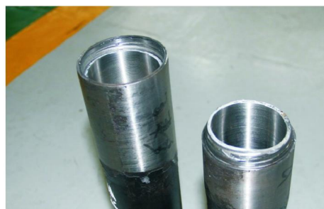
图 5 CNHT 试样静扭断裂后螺纹情况
