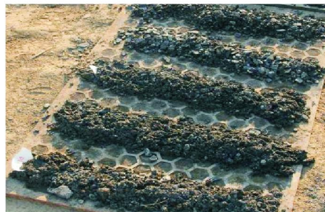
图4 牟页1井崩塌掉块图像信息
