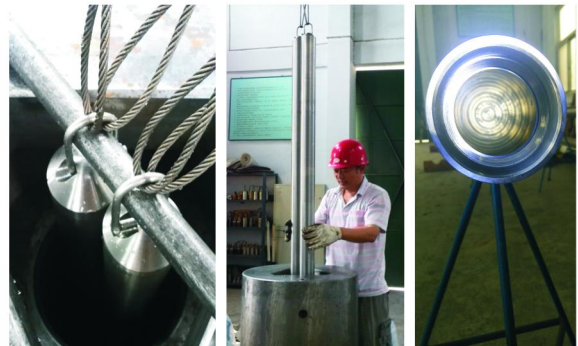
图6 承压管高压试验
