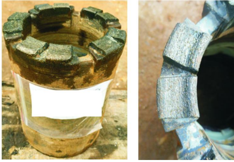
图6 使用后的 \varnothing 122 mm 金刚石钻头及出刃效果
