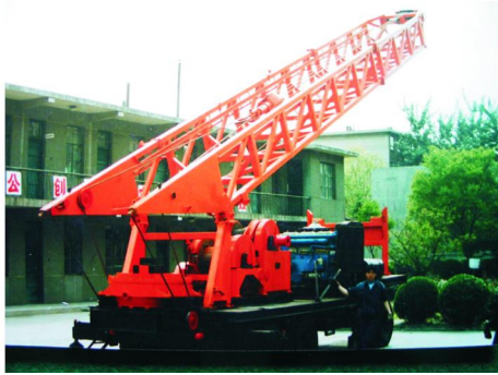
图9 SPT-600D型拖车钻机整体外观照片
