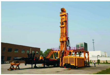
图5 北京天和众邦研制的 CMD-150 型 大吨位全液压力头模块化钻机
