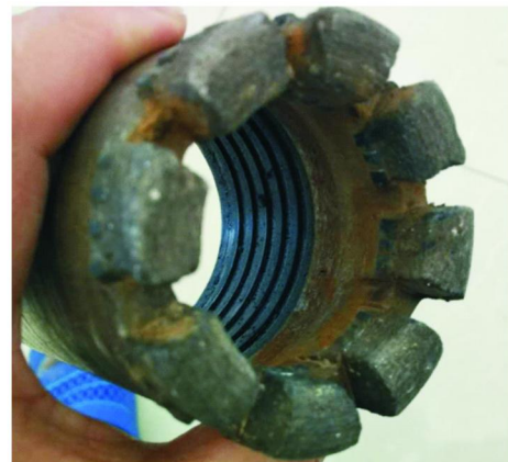
图4 NBS高效孕镶钻头进尺100m后磨损照片
