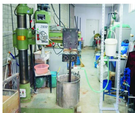
图 4 声频振动注浆试验装置实物图
