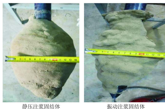
图 8 压力 6.6 kPa、频率 60 Hz 振动注浆与压力 13.3 kPa 静压注浆固结体对比图
