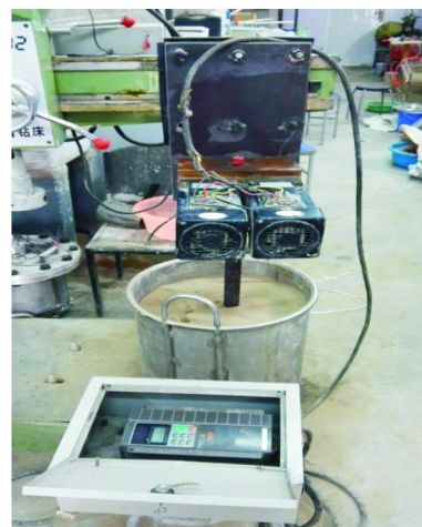
图 5 声频振动注浆所用变频器实物连接图
