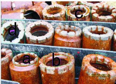
图3 ZK3201 金刚石钻头非正常磨损情况
