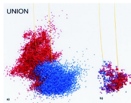
图 5 水力压裂在钻孔中造成微地震的测量结果——地震云
