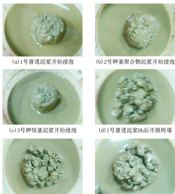
(a) 1号普通泥浆开始浸泡 (b) 2号钾铵基聚合物泥浆开始浸泡 (c) 3号钾铵基泥浆开始浸泡 (d) 1号普通泥浆9h后开裂垮塌 (e) 2号钾铵基聚合物泥浆22h后开裂垮塌 (f) 3号钾铵基泥浆28h后开裂垮塌
