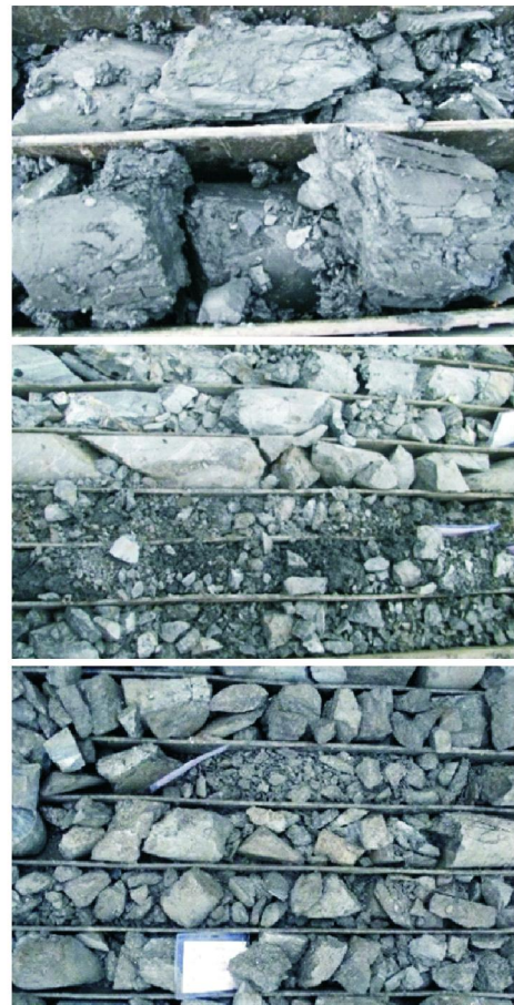
图5 ZK3-1钻孔取出的松散破碎岩心
