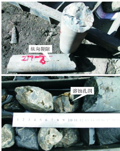
图2 地层溶蚀孔洞、纵向裂隙极其发育
