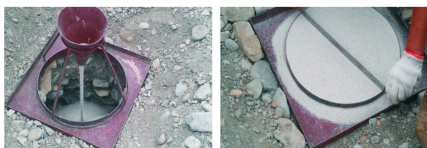
图 5 现场干密度试验(灌砂法)
