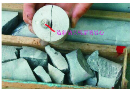
(b) 完全出新孔时的孔底岩心 (造斜钻头留下痕迹)
