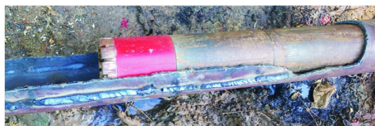
图8 \varnothing 114 mm 套管楔子, S95 钻具进入楔面
