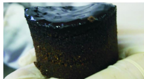
图1 砂床表面形成的封堵层
