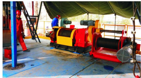
图 2 DB30 型多功能钻机(大口径钻进模式)
