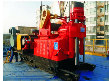
图 1 DB30 型多功能钻机(小口径钻进模式)
