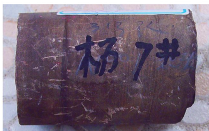
图 4 ZK04 孔细粉砂岩
