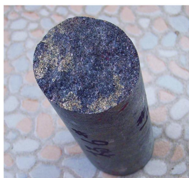
图 5 NLSD-1 孔角闪石英二长变粒岩
