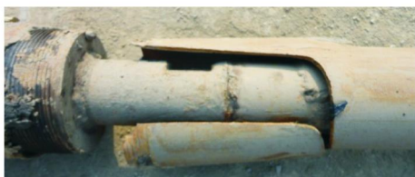
图4 用可退式捞矛处理上的事故钻杆
