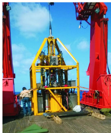
图 5 深海底岩心取样钻机总体外观
