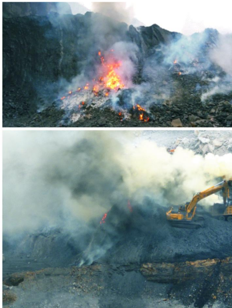
图7 山西宁武县昌元煤矿自燃和治理现场
