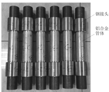
图2 “冷组装”铝合金钻杆试样
