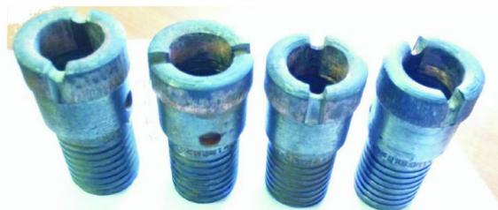
图4 低温试验用金刚石钻头
