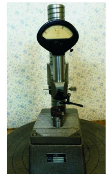
图6 测量钻头胎体唇面磨损用07201型显微测量仪
