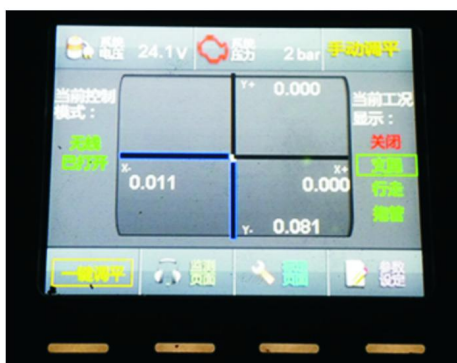
图 5 PA-10 型钢管柱安装机调垂结果
